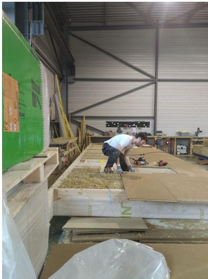
La paille transformée en mur dans une ossature bois dans une usine du Périgord - Gironde habitat
